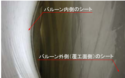
写真-2 散水後のバルーン内部 (散水開始から5分後)
