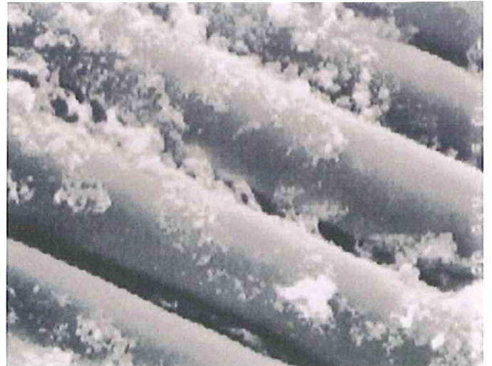
【電子顕微鏡写真】 界面境界でガラス繊維とモルタル成分結合しています。
