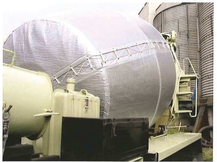
材質:発泡ポリエチレン5mm付き両面PEシート
