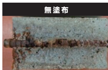
内在塩分 3.5 kg / m 3 の試験基材での腐食促進試験 31 サイクル後の鉄筋腐食状況
