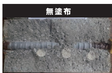
内在塩分を含まない試験基材での腐食促進試験 67 サイクル後の鉄筋腐食状況
