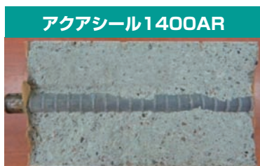
内在塩分 3.5 kg / m 3 の試験基材での腐食促進試験 31 サイクル後の鉄筋腐食状況
